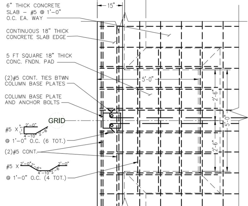
**C.2** TYPICAL EXTERIOR WALL FOOTING WITH STEM WALL - PLAN
