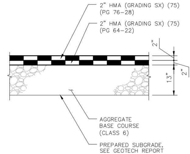
TYPICAL SECTION - ASPHALT PAD
