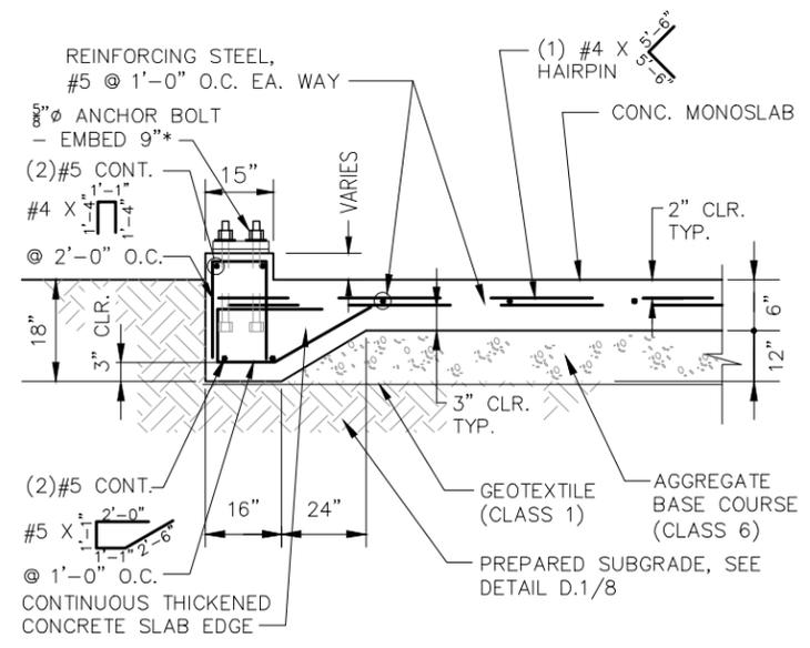
**D.2** TYPICAL SLAB DETAIL END WALL ANCHORAGE WITH STEM WALL
