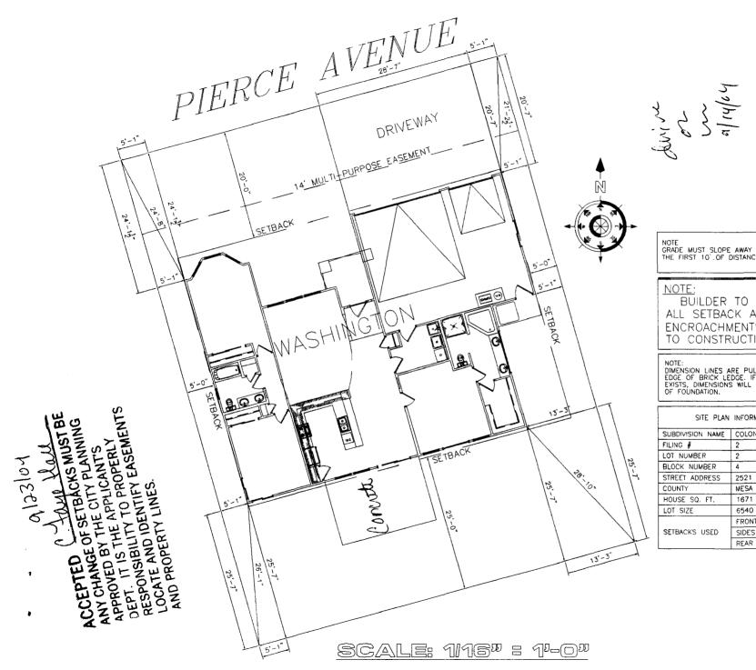
NOTE GRADE MUST SLOPE AWAY FROM HOUSE 6" OF FALL IN THE FIRST 10'. OF DISTANCE PER LOCAL BUILDING CODE.
