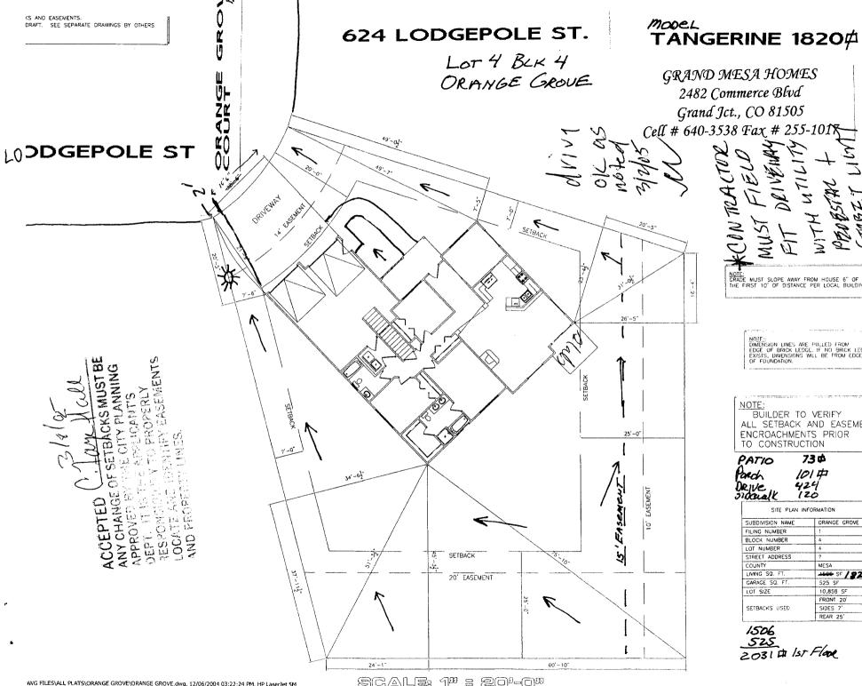
NOTE: GRADE MUST SLOPE AWAY FROM HOUSE 6" OF FALL IN THE FIRST 10" OF DISTANCE PER LOCAL BUILDING CODE.
